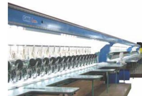
Barre in acciaio che non flettono, non vibrano e non necessitano di ingombranti supporti a "C"; si possono collocare macchine da ricamo di qualsiasi profondità, senza dover sostituire i supporti in caso di cambio macchine.
