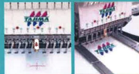
il puntatore laser con mirino rende più agevole il posizionamento del ricamo. il telaio magnetico consente di lavorare con materiali di qualsiasi forma.
