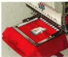
▲ Telaio pneumatico Clamp
