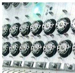
Un sensore monitora il filo nel suo movimento per tutto il tempo. Se il filo superiore o inferiore si rompe, questo sistema lo individua all'istante e ferma il processo di ricamo evitando così il proseguimento della produzione con il filo rotto. La sensibilità del sensore può essere regolata dal pannello di controllo in base al tipo di ricamo.
