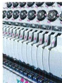
Coperture studiate appositamente sono state montate sulle leve tendifilo per evitare che i fili si aggroviglino durante le operazioni ad alta velocità e per migliorare la sicurezza dell'ambiente di lavoro.
