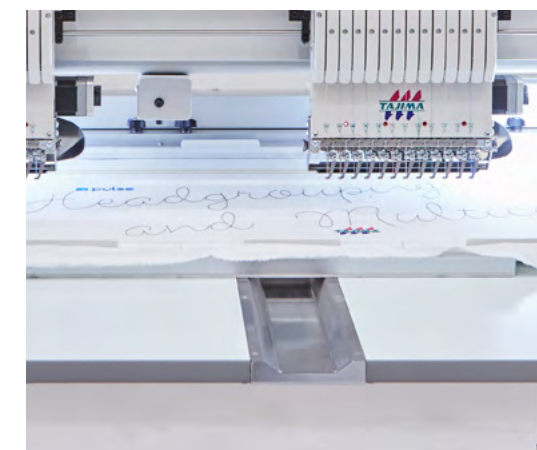
Guida centrale che stabilizza il telaio e la qualità del ricamo finale
